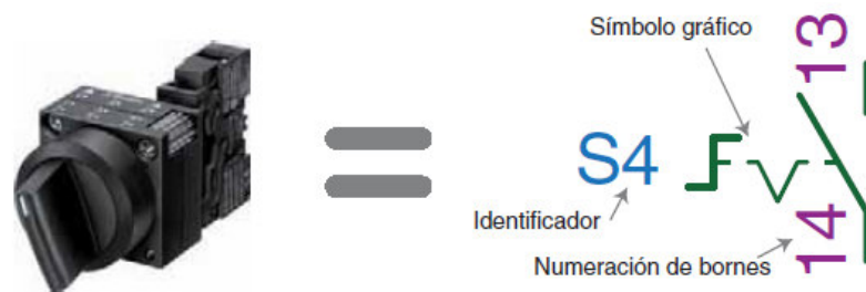
Figura 6.1. Partes de un símbolo eléctrico.
